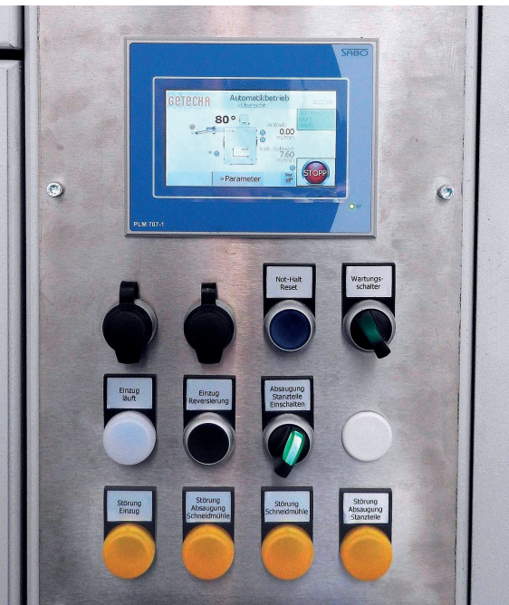
Bild 3: Alles im Blick: Bedienfeld mit Touchscreen an einer Getecha-Zerkleinerungsmühle mit integrierter Zu- und Abführtechnik
