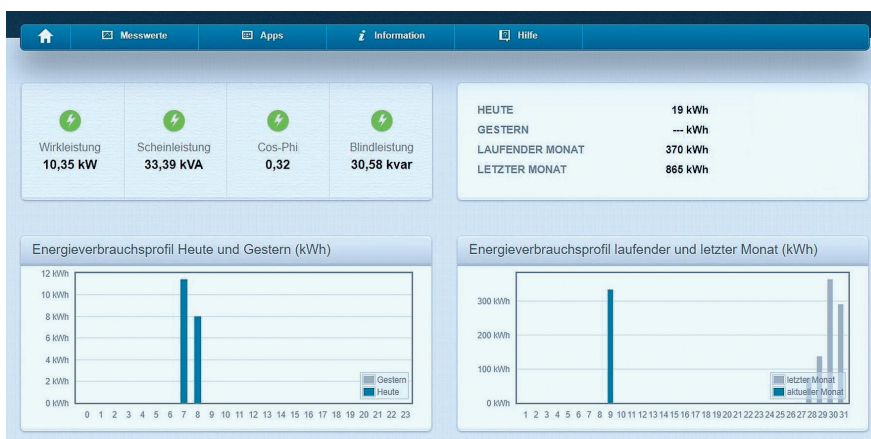
Bild 4: Das Energieverbrauchstool von Getecha ermöglicht die Effizienzüberwachung und Leistungsoptimierung der Zerkleinerungsanlagen
